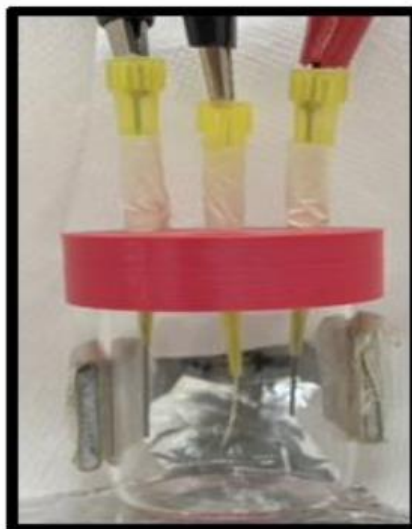
Figura 01: Ilustra a célula eletroquímica desenvolvida com grafites de lapiseira para detecção do rodenticida bromadiolona.
