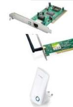
**Placa de Rede** : dispositivo responsável pela comunicação entre os computadores de uma rede. Sua função é preparar, enviar e controlar os dados na rede, interfaceando os computadores e o meio (cabos, rádio frequência, etc...)
